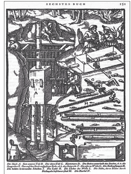
ABB. 01 Der Holzschnitt zeigt mit vielen Darstellungskonventionen eine Doppelkolben-Pumpe zum Entwässern der Grube [3].
